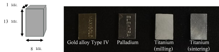
รูปที่ 1 วัสดุทางทันตกรรมชนิดโลหะผสม 4 ชนิด ขนาด 8x13x1 มม. 3
