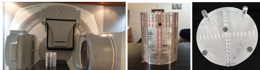
รูปที่ 2 การประเมินปริมาณรังสีที่ระยะความลึก (depth dose)
