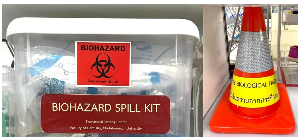
รูปที่ 19 Biohazard spill kit พร้อมสัญลักษณ์ความปลอดภัย เตือนอันตรายจากสารชีวภาพ ที่ถูกติดตั้งภายในห้องปฏิบัติการกลางและห้องปฏิบัติการ BSL2 ศูนย์ทดสอบชีววัสดุ
